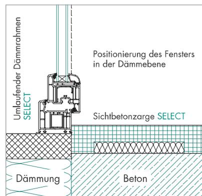
Das System erfüllt die Kriterien »konstruktive Vermeidung von Wärmebrücken« nach DIN 4108 Beiblatt 2 in vollem Umfang.
